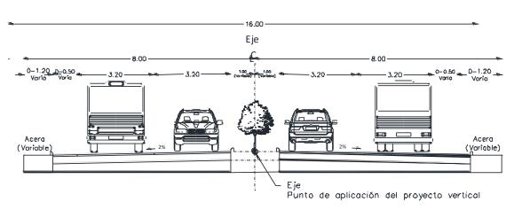
Ilustración 3: Sección típica de la vía, Tramo II Elaboración: Gerencia Comercial Fuente: Visor geográfico EPMMOP
