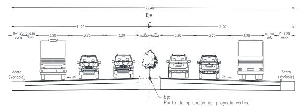
Ilustración 4: Sección típica de la vía, Tramo III Elaboración: Gerencia Comercial Fuente: Visor geográfico EPMMOP
