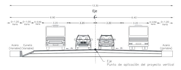
Ilustración 2: Sección típica de la vía, Tramo I Elaboración: Gerencia Comercial Fuente: Visor geográfico EPMMOP
