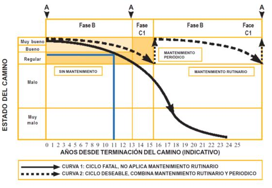
Ilustración 6: Condiciones de la vía con y sin mantenimiento
