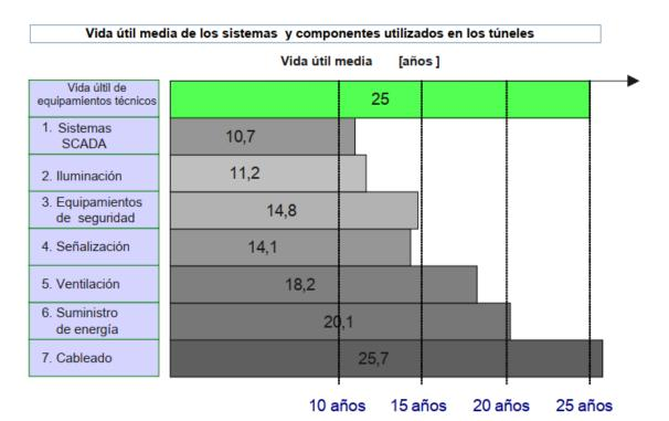
**Ilustración 7:** Ciclos de vida de los diferentes sistemas utilizados en túneles Fuente: Manual de túneles de carretera PIARC
